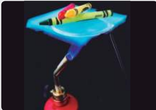
▲ El aerogel o humo sólido (debido a su apariencia) es uno de los mejores aislantes térmicos creados por el ser humano.
